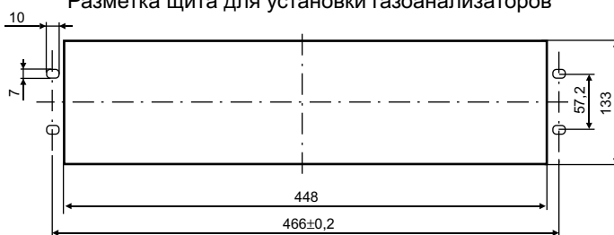
Разметка щита для установки газоанализаторов
